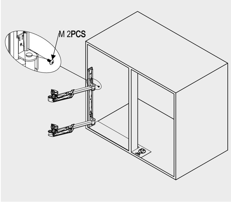
3. Установка изогнутого поворотного стержня
