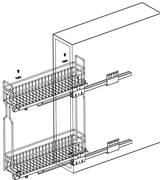
**1** Сделайте 4 отверстия ( $\approx 2,5$ мм) на боковой панели, как показано на картинке, и закрепите направляющие (A) к боковой панели с помощью 4 саморезов (B).
